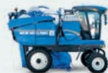
Die neue **VN2080** verschiebt abermals die Grenzen: Erstmals ist eine Erntemaschine für enge Weinberge mit der integrierten Abbeermaschine von SOCMA ausgestattet und erhält auf der SITEVI eine Silbermedaille.
