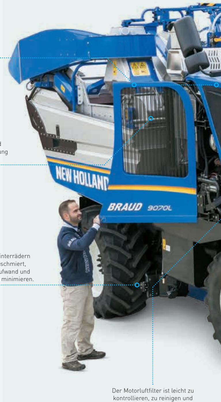
Der Motorluftfilter ist leicht zu kontrollieren, zu reinigen und auszuwechseln. Dafür werden keine Werkzeuge benötigt. Und er ist vom Boden aus zugänglich.
