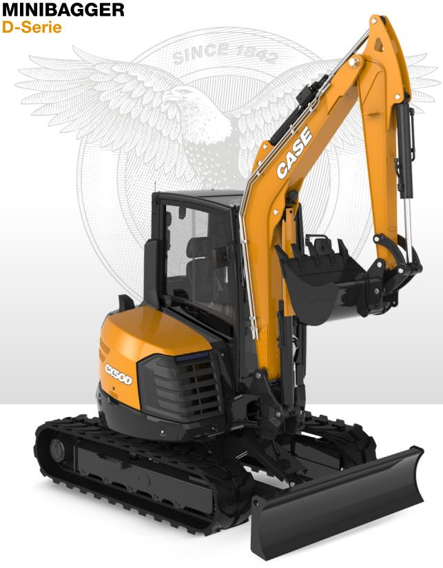
Motor V2403-CR-T Motorleistung 42,6 kW - 57,1 PS Einsatzgewicht 4950 kg
