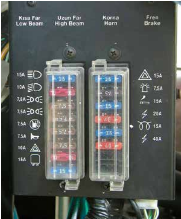
Todos los fusibles son del tipo automotriz y fácilmente identificados para detectar los desperfectos y reemplazar de forma más fácil.
