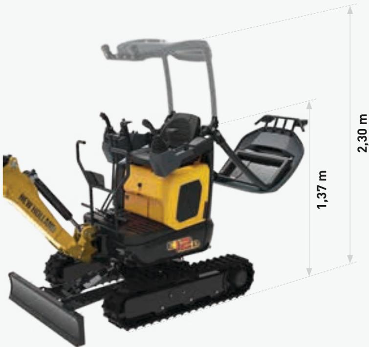
Möchten Sie einen Raum mit niedriger Decke oder Türöffnung befahren? Der einklappbare Überrollbügel ist einfach zu bedienen und ermöglicht so zum Beispiel das Durchfahren niedriger Türen und Tore. Außerdem kann der Bagger damit sehr kompakt abgestellt werden.
