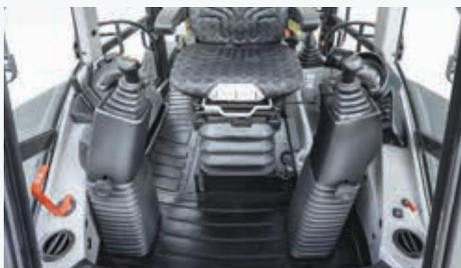
Montants des joysticks de la pelle-rétro réglables dans toutes les directions pour trouver la position la plus confortable.
