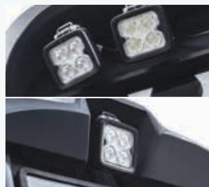
Jusqu'à dix éclairages de travail à LED, ainsi que des phares latéraux montés sur le toit, sont disponibles.
