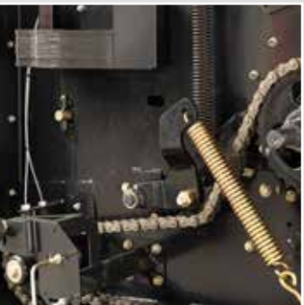
Grâce aux tendeurs à ressort, toutes les chaînes conservent une tension optimale, ce qui augmente leur durée de vie.
