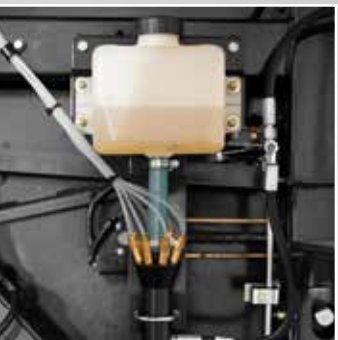
Le système de lubrification automatique réduit l'entretien quotidien au minimum.
