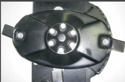
La barra de corte accionada por engranajes cerrada utiliza dos hojas de acero de alta calidad en cada disco ovalado de perfil bajo para producir un corte rápido y limpio. Los discos se retienen con seis pernos para facilitar el servicio.
