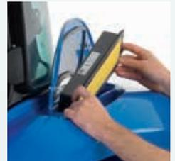
Der Kabinenluftfilter kann einfach gewechselt werden.
