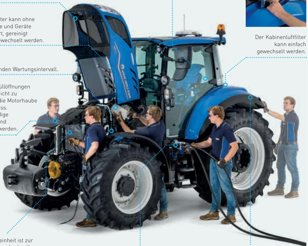
Der Einfüllstutzen des 12-Liter-AdBlue-Tanks ist schmaler als der des Standard-Kraftstofftanks, so dass ein unbeabsichtigtes Füllen mit Kraftstoff verhindert wird.
