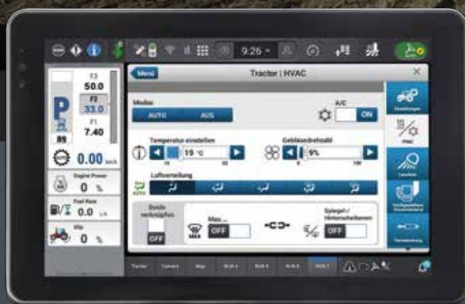
Il nuovo sistema di climatizzazione (HVAC) pressurizzato è dotato di più bocchette di ventilazione per aumentare il flusso d'aria nella zona dell'operatore. Inoltre può essere regolato direttamente tramite l'encoder o i pulsanti configurabili.
