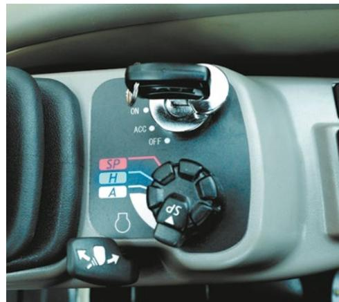
Операторы могут сохранять до **десяти дополнительных настроек расхода гидравлического масла** (и давления гидравлического масла по заказу), что позволяет им легко и быстро менять навесное оборудование без необходимости каких-либо механических регулировок.
