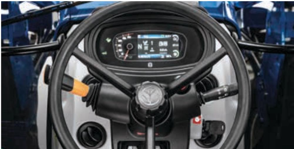
Das neue Armaturenbrett mit Digitalanzeige zeigt alle wichtigen Leistungsparameter wie Kraftstoffstand und Motordrehzahl klar und gut lesbar an. Gleichzeitig können Einstellungen wie die Auto-Funktion der Zapfwelle darüber vorgenommen werden. Die Navigation erfolgt über Kippschalter, sodass der Fahrer jederzeit über den Status der wichtigsten Traktorparameter informiert ist
