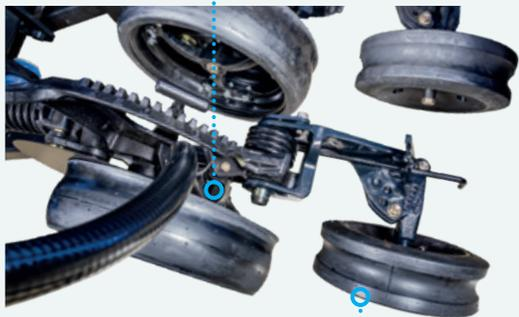
La roue de fermeture peut être ajustée à 4 positions indexées différentes : 0,5°, 6°, 9° ou 13°. Un seul changement d'angle assure la flexibilité nécessaire pour s'adapter à la fermeture de diverses conditions du sol.
