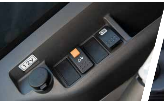
Schalter für den hydraulischen Schnellwechsler
