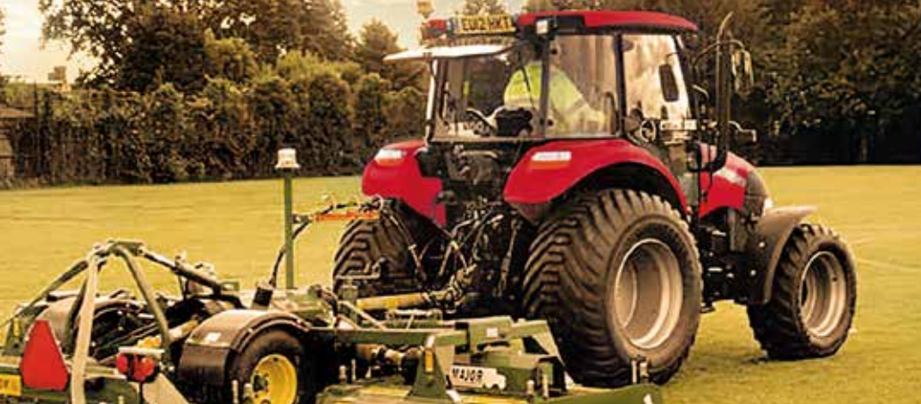
Däck med icke aggressiva slitbanor är lämpliga för gräsytor.
