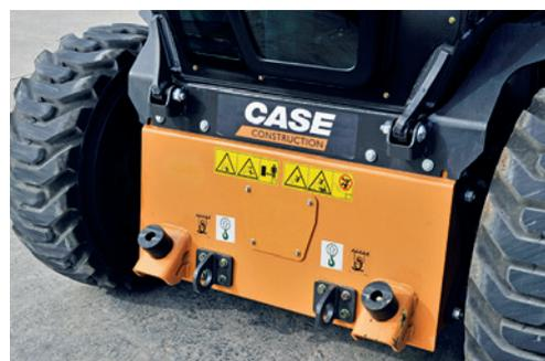
Direkte Abstützpunkte am Fahrwerksrahmen unterstützen die Schubleistung
