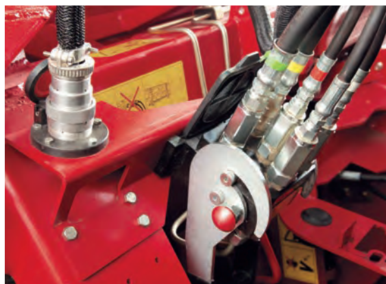
Montez la barre de coupe en quelques minutes avec le loquet unique qui connecte instantanément tous les circuits hydrauliques.
