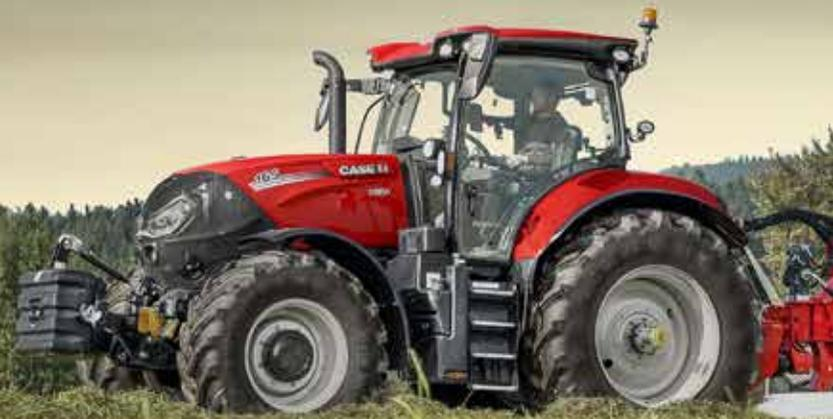
El motor de 4 válvulas y 6,7 litros, con sistema de inyección de combustible de alta presión Common Rail y turbocompresor con válvula de descarga, proporciona rendimiento, par, ahorro de combustible y fiabilidad entre 140 y 180 CV (nominales). Todos los modelos incluyen gestión de potencia del motor para elevar esas cifras a 175 - 225 CV en tareas con la toma de fuerza, hidráulicas y de transporte.
