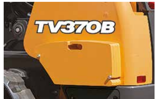
Contrepoids additionnel pour augmenter le ROC
