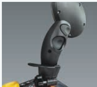
Botones de cambio y desbloqueo del avance (detrás del joystick).
