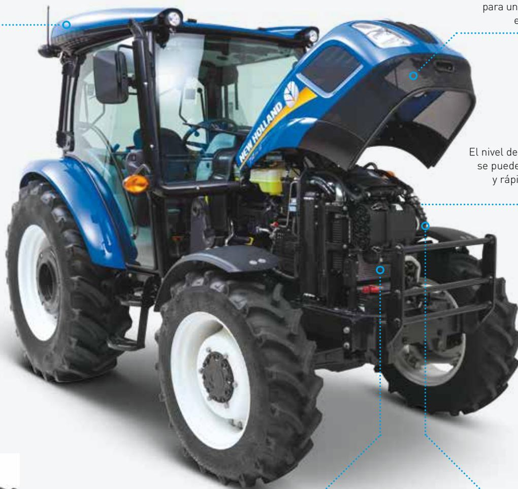
El nivel de aceite del motor se puede comprobar fácil y rápido sin necesidad de abrir el capó.
