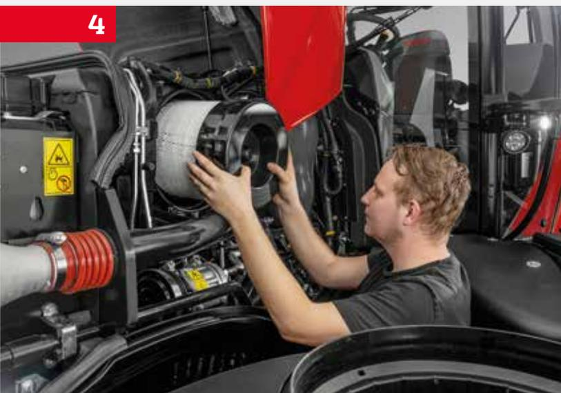
4 Kontinuierliche Reinigung über einen **PICLON-FILTER** sorgt dafür, dass der Filter nur gewartet werden muss, wenn die entsprechende Warnleuchte angeht.
