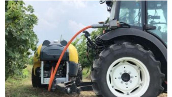
EL GENERADOR E-SOURCE (DE FUENTE ELÉCTRICA) ESTÁ EQUIPADO CON UN CONECTOR FLEXIBLE, LO QUE LO HACE COMPATIBLE CON MAQUINARIA DE DIFERENTES TAMAÑOS.
