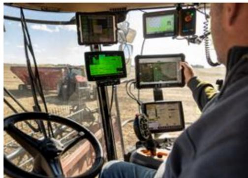
EL SISTEMA OMNIDRIVE™ DE RAVEN PERMITE A UN AGRICULTOR OPERAR UNA COSECHADORA Y CONTROLAR UN TRACTOR SIN CONDUCTOR. DERECHA: A FINALES DE 2022, LOS PULVERIZADORES DE LA SERIE CASE IH PATRIOT 50 INCLUIRÁN LA TECNOLOGÍA RAVEN. PÁGINA OPUESTA: EL SISTEMA DE GUÍA VISUAL VSN™ DE RAVEN GUÍA A LOS PULVERIZADORES A LO LARGO DE LAS FILAS DE CULTIVOS SIN DAÑARLOS.
