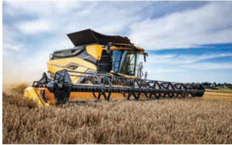
O motor Cursor 13 de 12,9 litros da CR10 debita até 634 CV a 1800 rpm e está equipado com um depósito de gasóleo de 1300 litros, para maximizar a produtividade diária. A CR11 está equipada com um motor Cursor 16 de 15,9 litros da FPT. Este motor potente debita até 775 CV a partir dos seus seis cilindros, garantindo que não só lida com grandes volumes de cultura, como também domina a tarefa de os processar.
