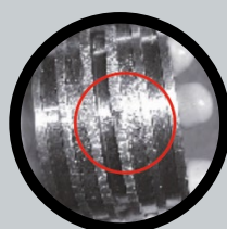
USZKODZENIE TŁOKA POMPY
