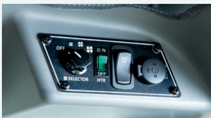
Système de chauffage comprend un ventilateur à plusieurs vitesses
