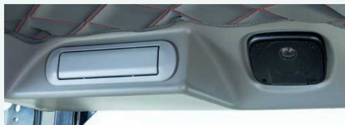
Câblage pour la radio avec des haut-parleurs et une antenne préinstallés
