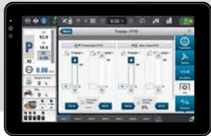
DISPOSICIÓN INTUITIVA DEL AJUSTE AUTOMÁTICO DE ACTIVACIÓN/DESACTIVACIÓN DE LAS TOMAS DE FUERZA TRASERA Y DELANTERA, DEPENDIENTES DE LA ALTURA
