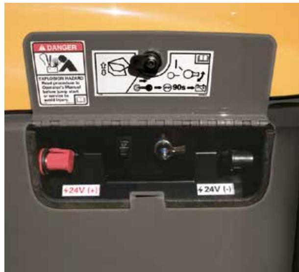
Ouverture du capot et interrupteurs de mise en marche et d'arrêt de la batterie. En cas de batterie déchargée, l'ouverture du capot peut se faire de l'extérieur avec un démarrage à distance
