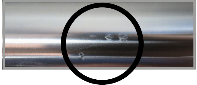
PISTON CONTAMINÉ PAR DES PARTICULES
