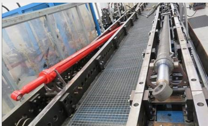
Essai comparatif pièces d'origine/concurrents.
