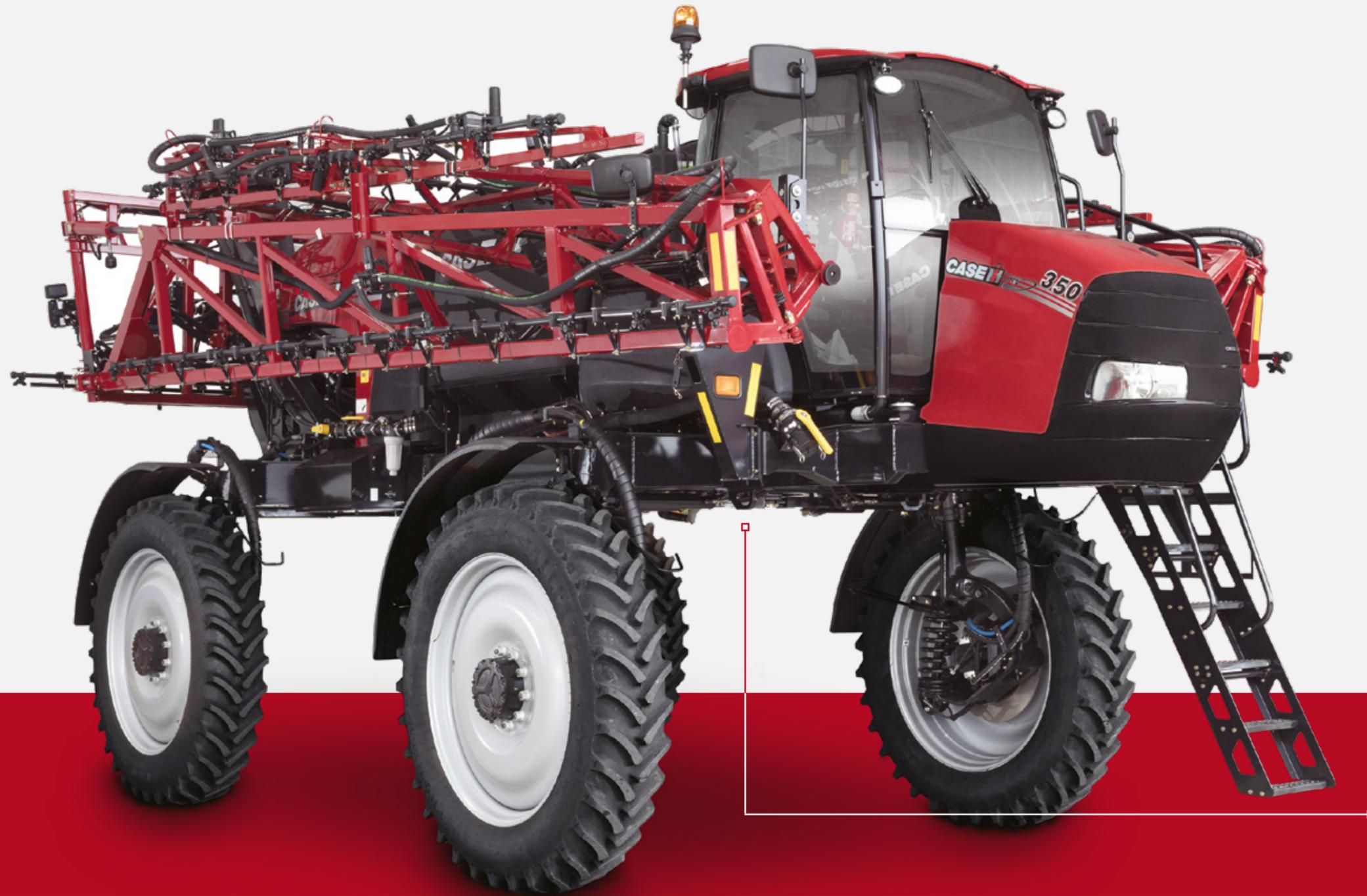
Su motor Case IH FPT NEF de 250 hp, 6 cyl., 6.7 litros, ubicado en la parte trasera, la cabina en la parte delantera y el tanque de producto centralizado proporcionan una excelente distribución del peso y una excelente estabilidad, además de una menor compactación del suelo.
