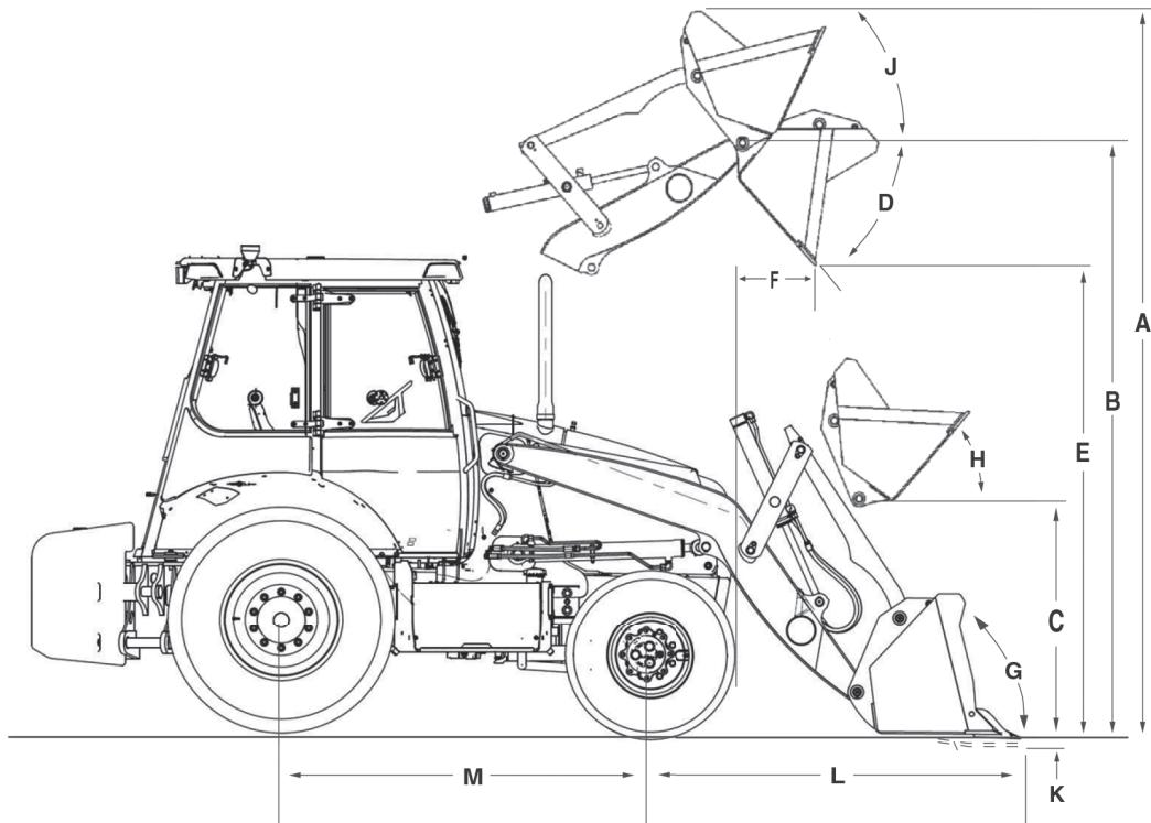
Tração 4x4 com pneus traseiros 19,5x24 e caçamba dianteira de uso geral de 93". \*Eixo dianteiro 4x4 padrão com pneus 12x16,5. \*\*Eixo dianteiro 4x4 HD com pneus 12,5/80x18.
