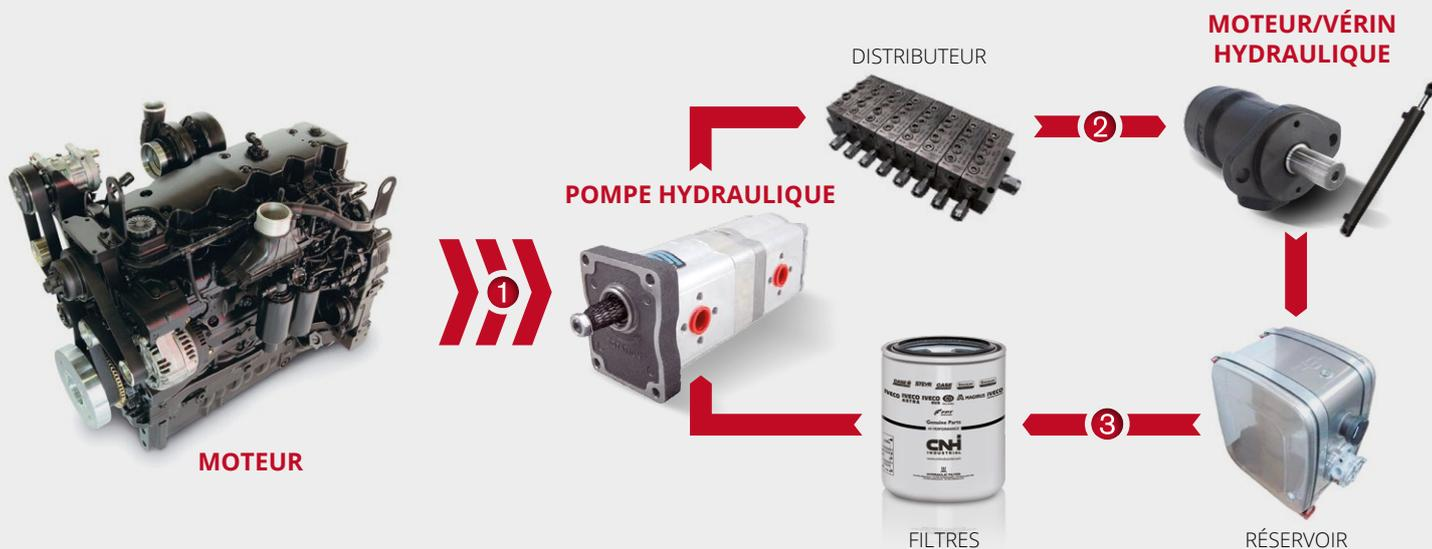
1 L'énergie mécanique entraîne la pompe hydraulique qui prélève l'huile dans le réservoir.
