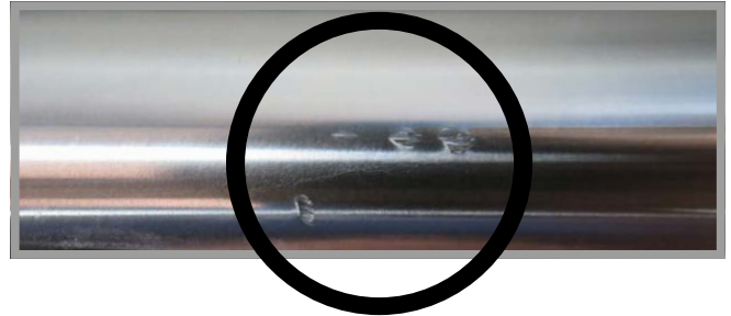
PISTON CONTAMINÉ PAR DES PARTICULES
