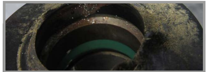
PISTON CONTAMINÉ PAR DES PARTICULES
