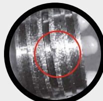
BESCHÄDIGUNG DES PUMPENKOLBENS
