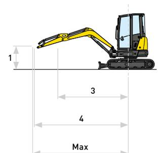
La capacidad de elevación se basa en la norma ISO 10567 y no supera más del 75% de la carga de vuelco estática, ni más del 87% de la capacidad de elevación hidráulica de la máquina.
