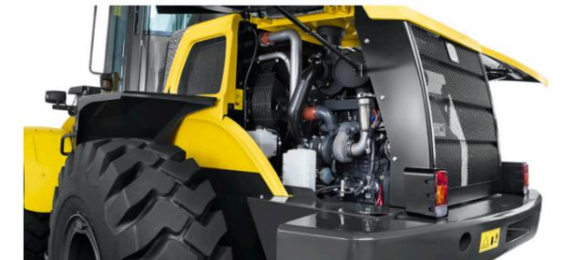
Motor Tier IIIA con 3 curvas de potencia, el cual entrega elevado torque a los diferentes tipos de trabajo, utilizando toda la potencia del combustible, lo que resulta en bajo costo operativo.
