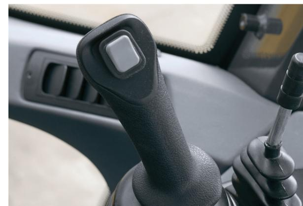
Botón de inversión de dirección frente/atrás ubicado en la palanca de control del accesorio frontal, ofreciendo ciclos más rápidos y confort de operación.
