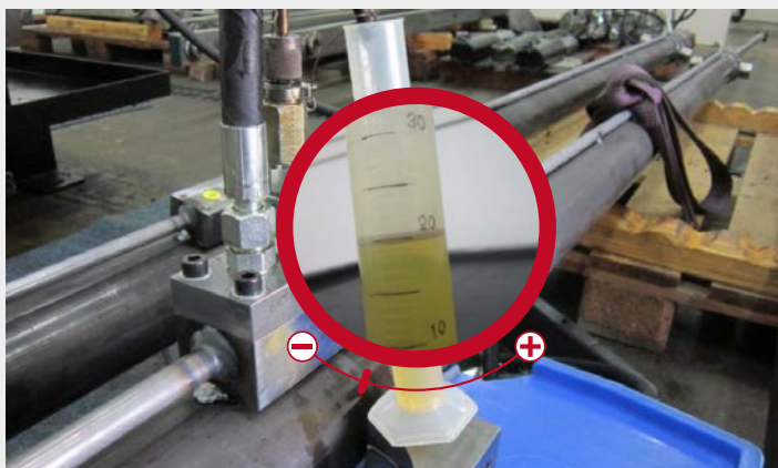
Test di perdita interna e esterna.
