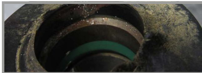
PISTONE CON CONTAMINAZIONE DA PARTICELLE
