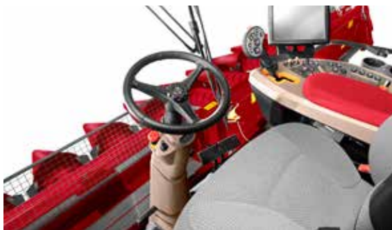
Columna de dirección plegable con nuevo interruptor de emergencia y volante telescópico extensible: visibilidad sin obstáculos
