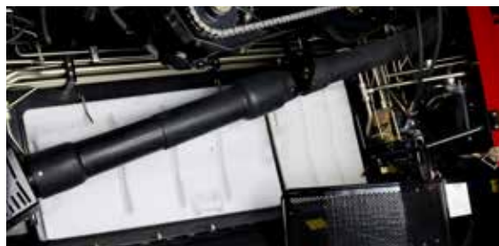
La transmisión Power Plus transfiere una gran potencia al elevador de alimentación y al cabezal. Diseño sencillo y de bajo mantenimiento
