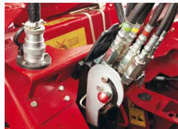
Monta el cabezal en cuestión de minutos utilizando el cierre único que conecta todos los servicios hidráulicos y eléctricos
