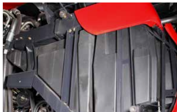
1.125 litros de capacidad de combustible (7250, 8250) o 1.200 litros (9250) para largas jornadas de trabajo. Equipado con el picador Xtra-Chopping, el modelo 9250 tiene 1.020 litros de capacidad
