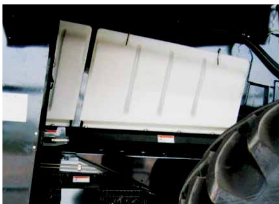
Excelente acceso para mantenimiento en el lado izquierdo retirando las cubiertas de plástico blanco moldeado
