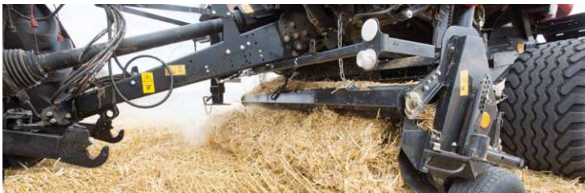
Depósito en hileras de paja larga o corta para pacas perfectamente formadas
