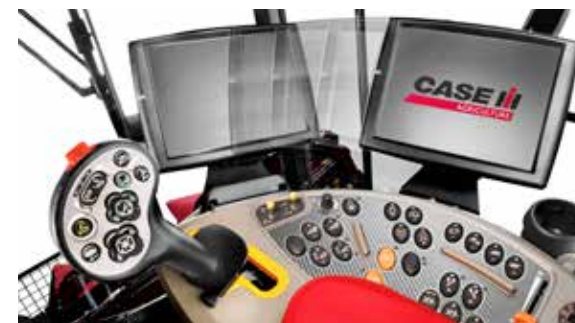
Posicionamiento del monitor AFS Pro 700 para obtener la mejor visibilidad
