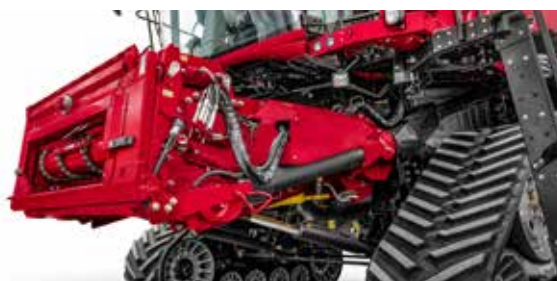
Inclinación adelante/atrás para ajustar el ángulo del cabezal: recogida completa del cultivo encamado, pérdidas mínimas
