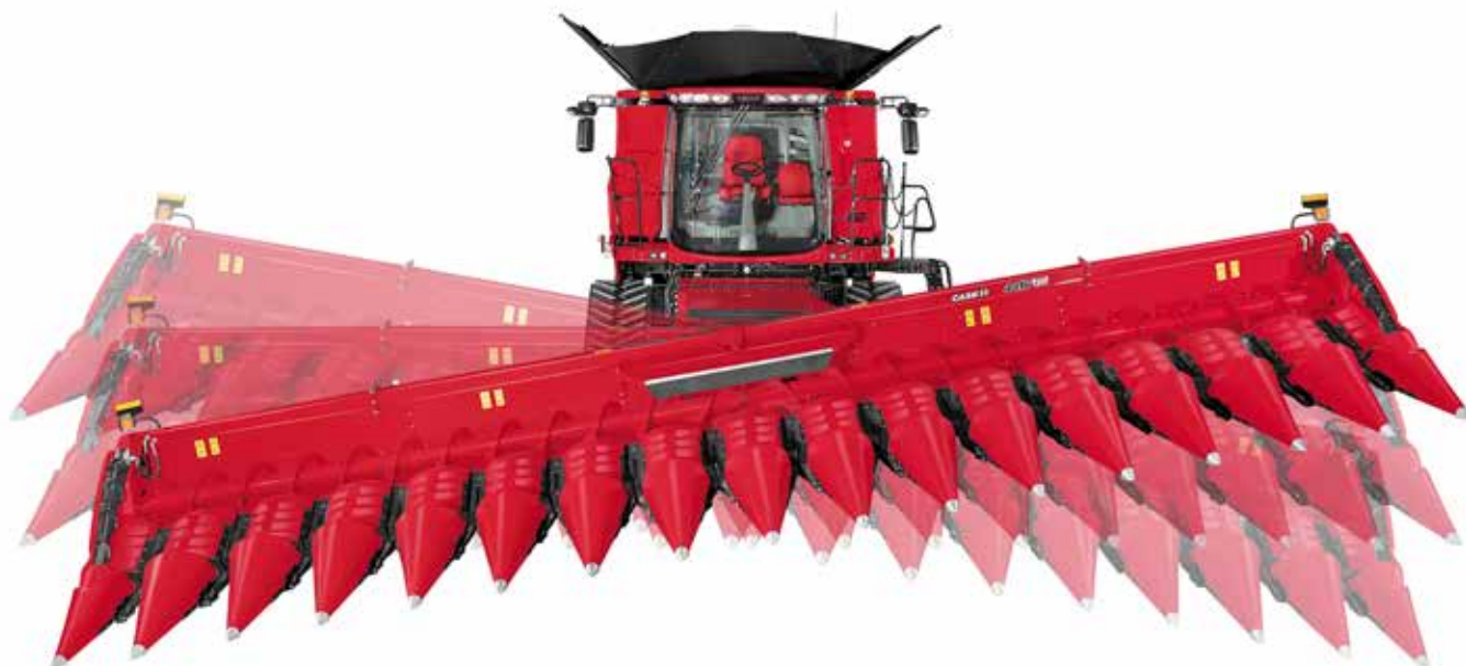
La tecnología Terrain Tracker de Case IH garantiza el mantenimiento de una altura de corte exacta en la mayoría de los campos irregulares
