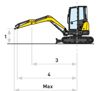
La capacità di sollevamento è basata sulla ISO 10567 e non supera più del 75% del carico di ribaltamento statico o più dell'87% della capacità di sollevamento idraulico della macchina.
