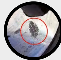
DESGASTE DE LA VÁLVULA
