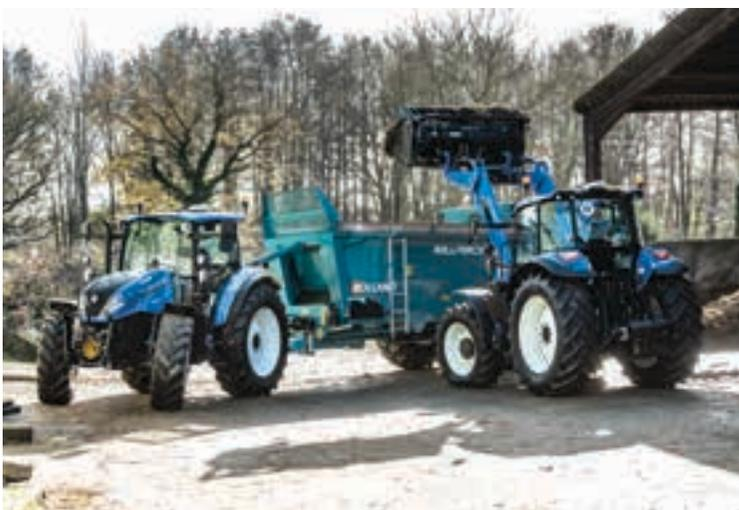
Se poi si equipaggia il New Holland T5 con il sollevatore e la PdP frontali si otterrà un trattore ancora più versatile. La nuova PdP con frizione in bagno d'olio è esente da manutenzione e garantisce un funzionamento più silenzioso.
