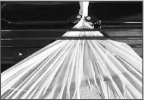
Double système de liage avec filet et film plastique
