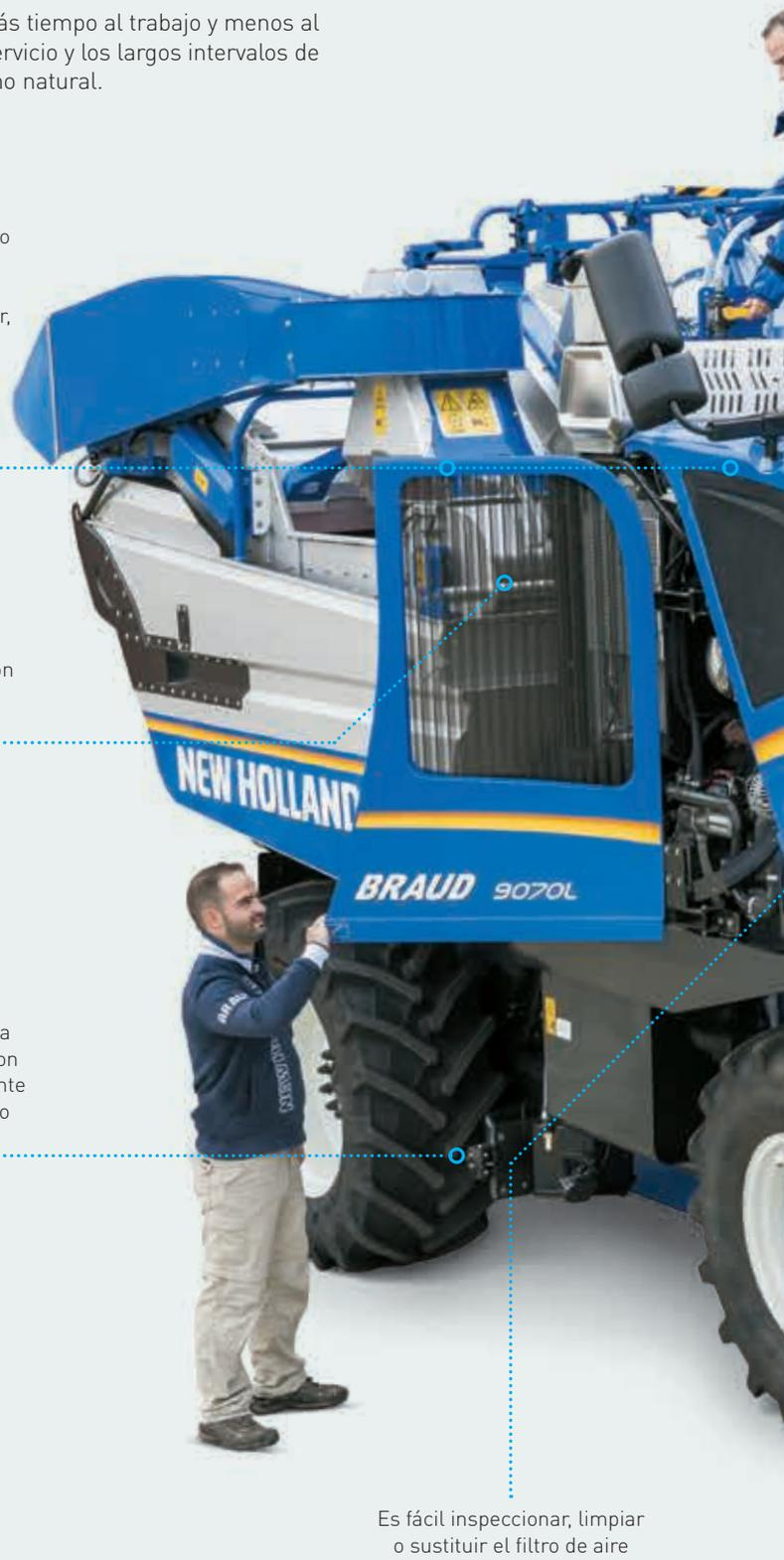
Con la plataforma de acceso especialmente diseñada, la manguera y llave de suministro de agua, y el acceso a las diferentes funciones para facilitar el lavado desde un mando a distancia, jamás ha sido tan fácil el lavado.
