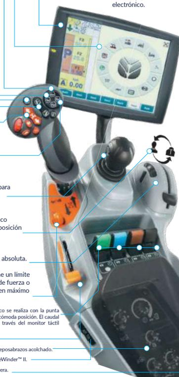
Fácil acceso a las funciones avanzadas. Pulse el símbolo y active la función. El panel de control integrado ICP facilita el acceso a las funciones operativas avanzadas.
