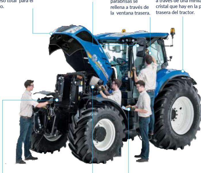
El sistema de refrigeración se abre para facilitar y agilizar la limpieza.
