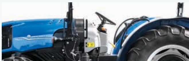
Arceau central de sécurité ROPS avec vérin d'assistance à gaz pour arboriculture fruitière
