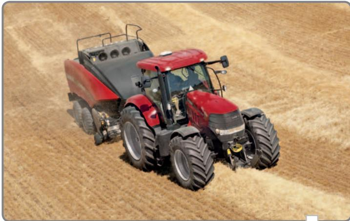
Для предоставления современной и точной информации для эффективной работы пресс-подборщиков они снабжены системами сбора данных, которые поставляют подробную информацию по параметрам для каждой связки (влажность, вес и расположение в поле).
