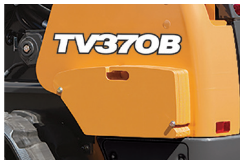
Contrepoids additionnel pour augmenter le ROC
