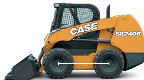
ROC une grande stabilité, grâce à l'empattement long
