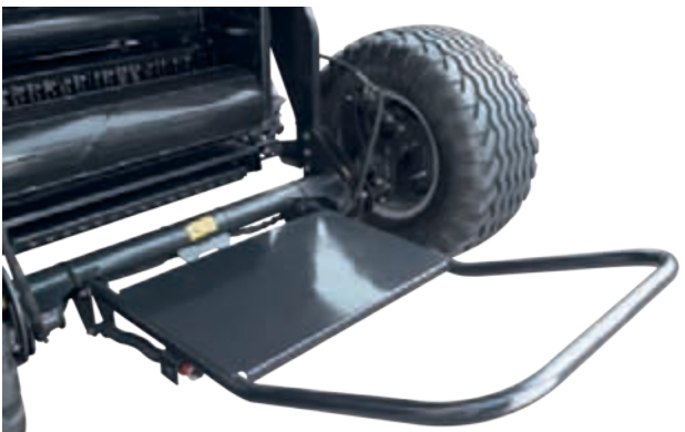
En udkasterfunktion ruller ballen væk fra presseren, så bagklappen kan lukkes.
