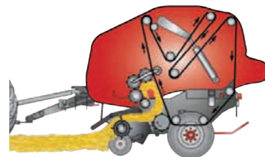
Kombinationen af remme og formningsvalser giver optimal balleform og presningsgrad.
