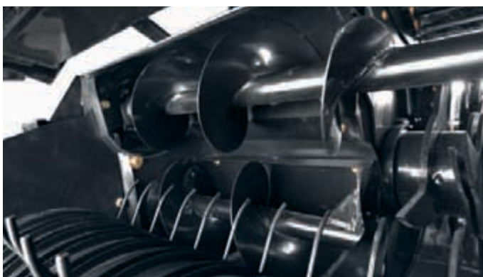
Indføjingssnegle for højere kapacitet, forbedret indføring og mindre omvikling.
