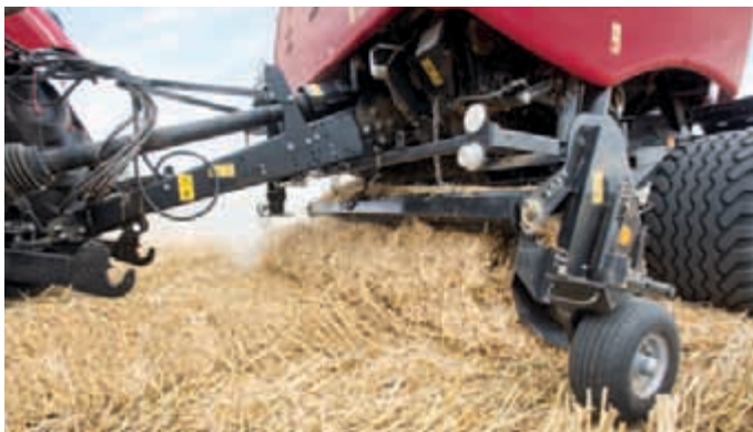
5 rørs pick-up med effektiv opsamling af meget kort afgrøde ved høje hastigheder.
