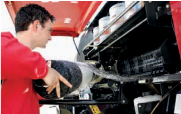
Let at montere bindegarn eller netruller.
