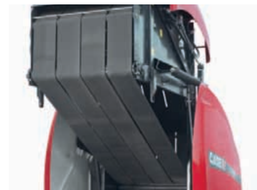
Fire endeløse remme sikrer præcist greb om ballen.
