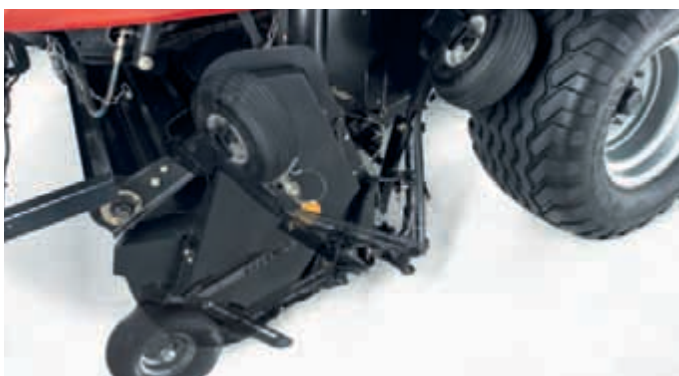
Nyt støbt pick-up hjul kan vippe op under transport eller sættes i arbejdsposition uden brug af værktøj.
