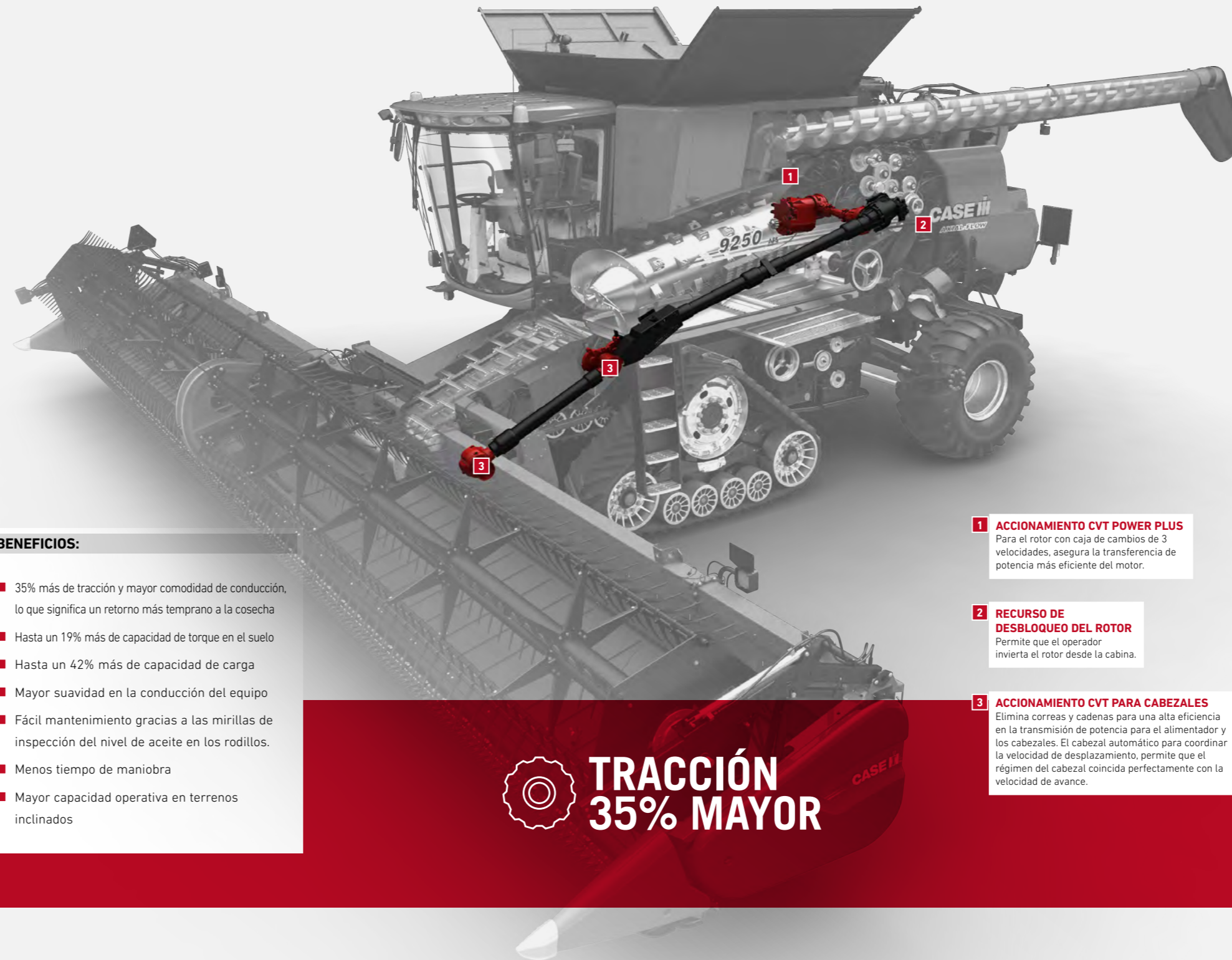
Nuevo accionamiento hidrostático y transmisión para mayor tracción. Los frenos de aceite ofrecen una potencia de frenado constante.
