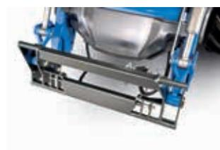
600LA e 700LA - Bloccaggio attacco idraulico
