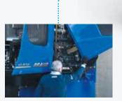
La apertura total del capó del motor de dos piezas ofrece acceso completo para el mantenimiento: la pieza frontal totalmente abatible facilita el acceso al motor, mientras que la puerta lateral se mueve con un amortiguador de gas para la limpieza y el mantenimiento del sistema hidráulico y los radiadores.
